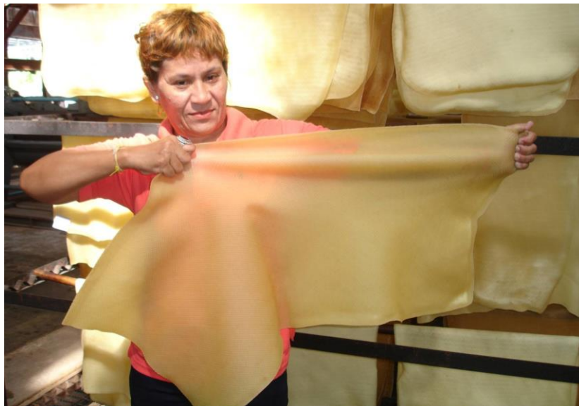
รูปที่ 6 ยางแผ่นอบแห้งที่มีคุณภาพดี เมื่อตั้งแล้วปล่อยให้สามารถหดกลับเข้าสู่สภาพเดิมได้ง่าย
