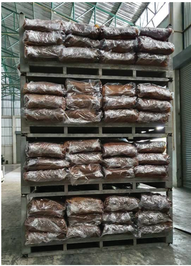
ภาพที่ 10 พาเลทคอนโดขนาด 1.5 x 2.2 เมตร วางยางมัดซ้อนกัน 3 ชั้น ๆ ละ 12 มัด นำพาเลทซ้อนกันไม่เกิน 4 ชั้น วางห่างจากฝาผนังอย่างน้อย 1.2 เมตร
