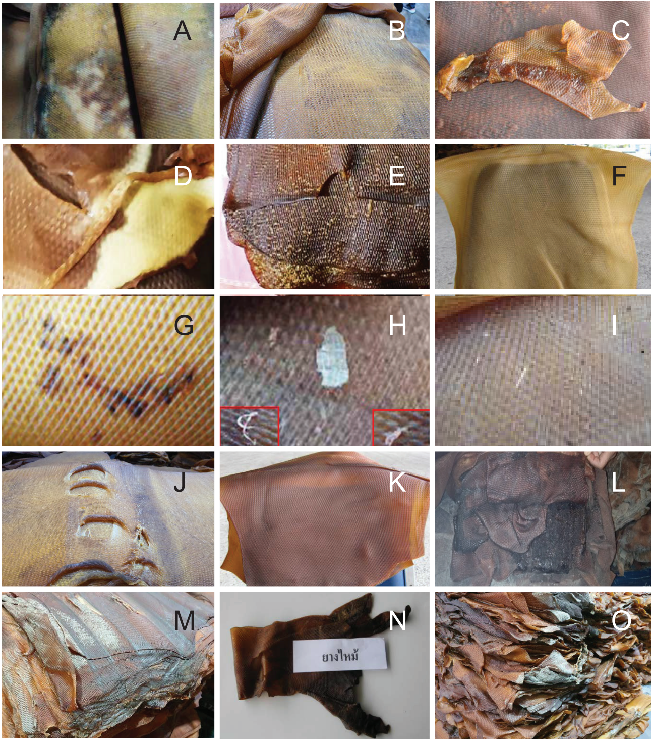
ภาพที่ 5 ตัวอย่างยางแผ่นรมควันที่ไม่ได้คุณภาพ ที่ทำให้ไม่สามารถจัดชั้นได้ A: ยางเกิดเขี้ยว, B: ยางเหนียว, C: ยางเหนียว, D: ยางดิบ, E: ยางพอง, F: ยางอ่อนรม, G: เศษขี้ยางปน/จุดสีดำ, H: เศษสิ่งปนเปื้อน, I: เศษไม้ เศษกรวดทราย, J: ถูกสารถไฟล็คลิฟท์, K: ยางที่บ เนื่อกระด้าง, L: ยางย้วย/เยิม, M: ยางไหม้/ร่องรอยพาเลท, N: ยางไหม้, O: ยางไหม้/รมควันไม่สม่ำเสมอ
