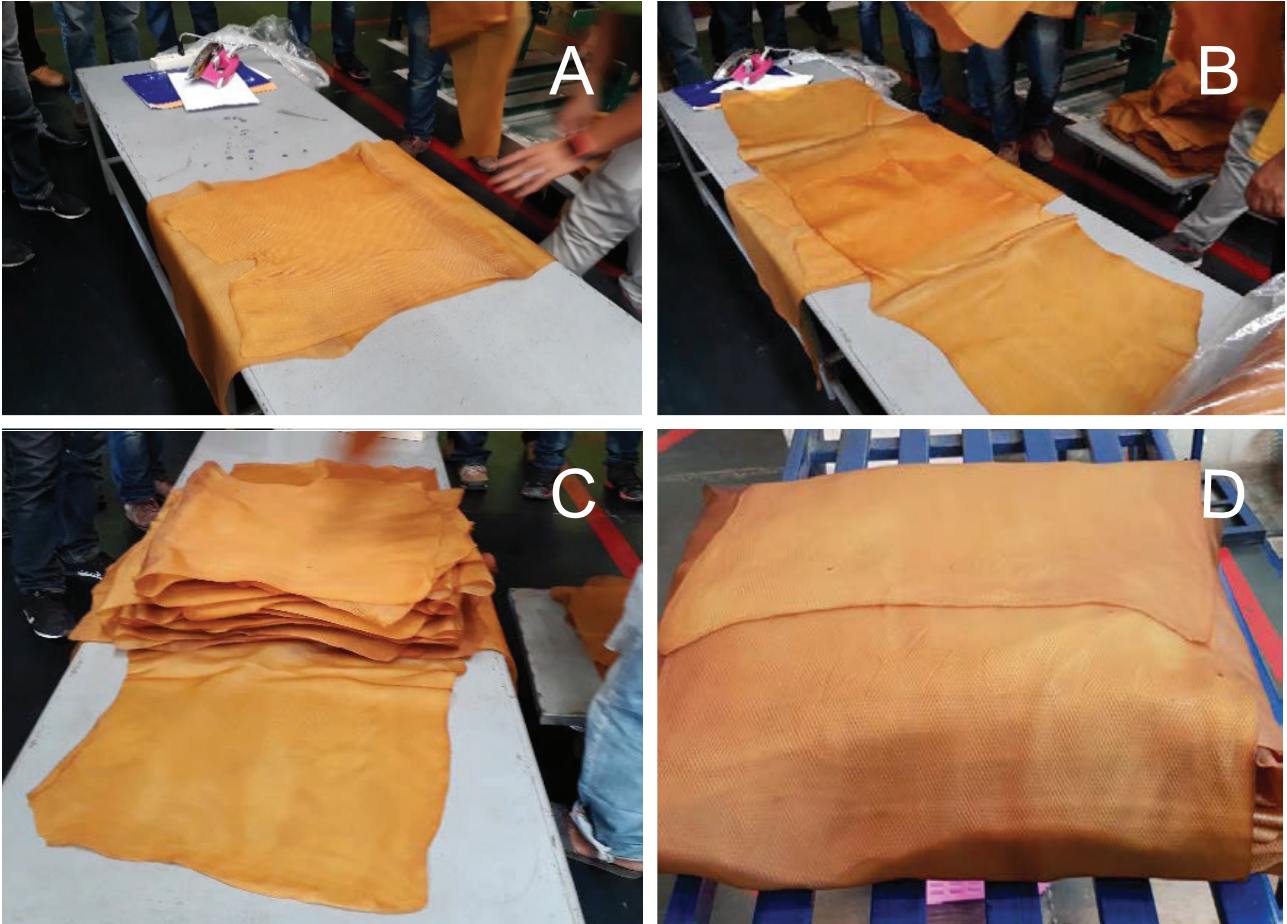
ภาพที่ 7 วิธีการหีบห่อยางแผ่นรมควันแบบมัด A: วางยางแผ่นสองแผ่นตามความยาว, B: วางยางแผ่นอีกสองแผ่นในแนวขวาง, C: พับครึ่งยางแผ่นแต่ละแผ่น เรียงซ้อนทับกัน วางตรงกลาง สลับไปมา, D: ยางแผ่นรมควันแบบมัด
