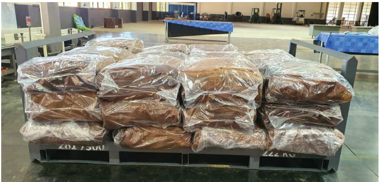
ภาพที่ 8 ยางแผ่นรมควันแบบมัดบรรจุในถุงพลาสติกโพลีเอทิลีนความหนาแน่นต่ำ (LDPE)
