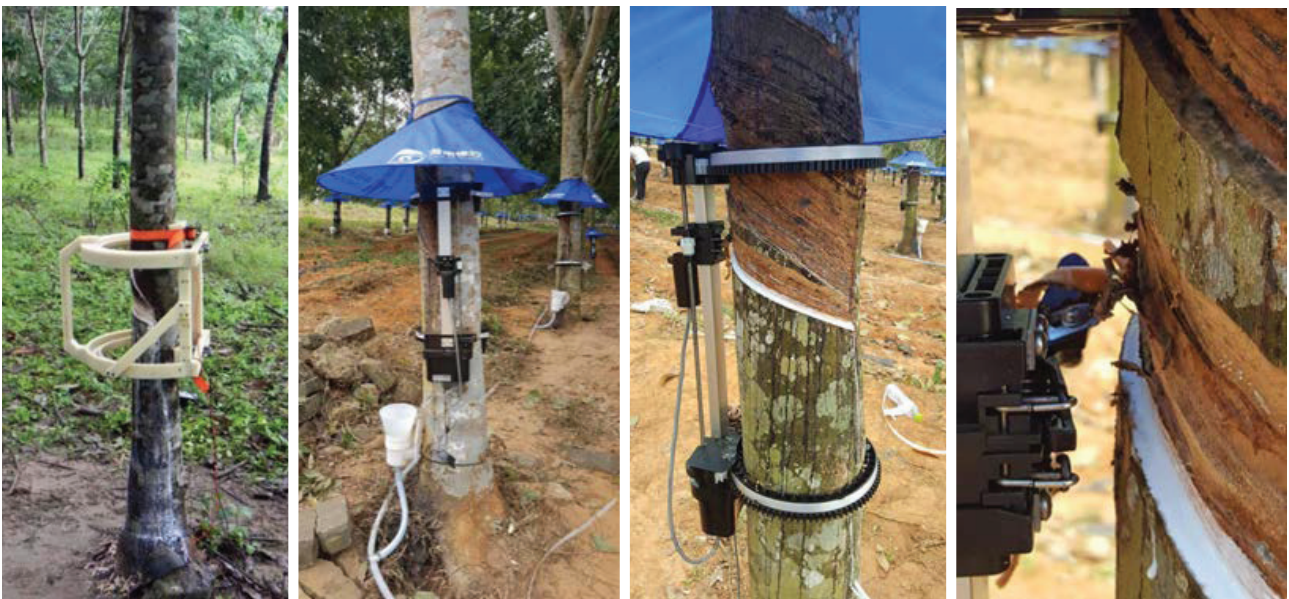
ภาพที่ 1 เครื่องกรีดยางอัตโนมัติที่พัฒนาโดยบริษัท รับเบอร์ วัลเลย์ จำกัด
