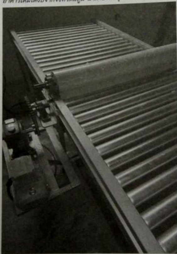
เครื่องล้างและรีดน้ำและสารเคมีออกจากหมอนยางพาราหลังจากนึ่งไอน้ำ
