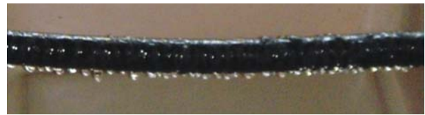
ท่อน้ำซึมจากยางพารา
